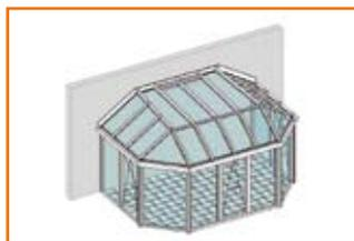
Pultdach mit Solarknick, beidseitig seitlich abgewalmt mit abgeschrägten Rinnenecken
